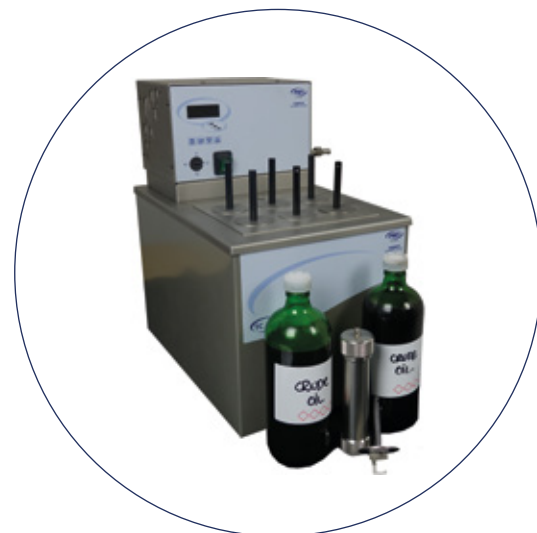
Pour Point of Crude Oils
